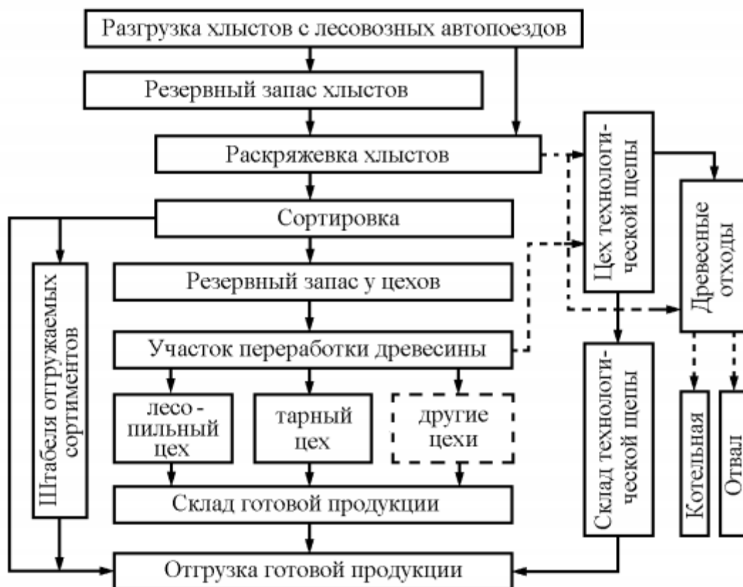
Рисунок 8.1 – Структурная схема технологического процесса прирельсового нижнего склада при вывозке на склад хлыстов
