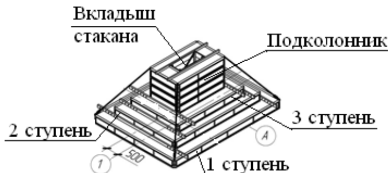
Рисунок Б.10 – Схема опалубки фундамента
