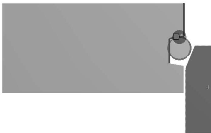
Рисунок 5.2 – Задание контакта между кромками цилиндра и кольца
