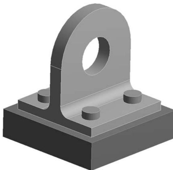
Рисунок 6.1 – Болтовое соединение проушины и основания
