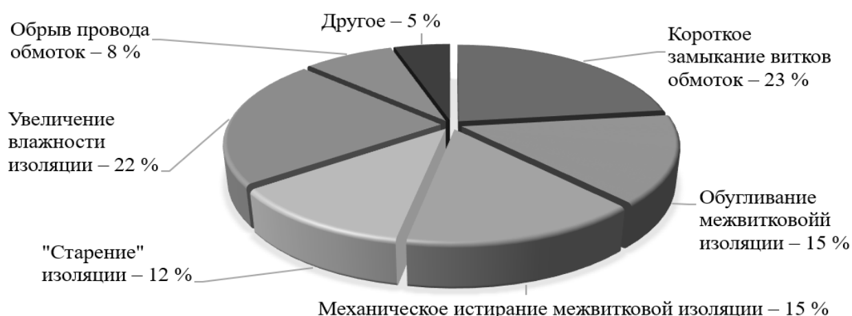
Рис. 2. Причины неисправного состояния изоляции в эксплуатируемых электрических машинах
