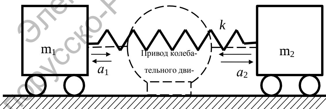
Рис. 1. Модель двухмассовой колебательной системы
