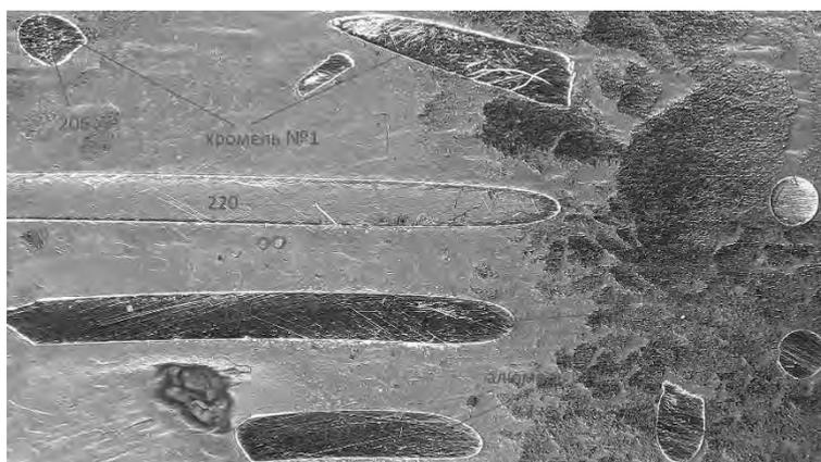
Рис. 2. Значения твердости HV продольных и поперечных сечений хромеля и алюмеля
