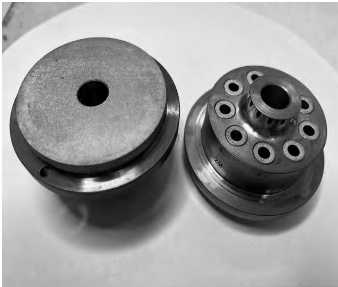
Рис. 1. Деталь блока цилиндров, изготовленная диффузионной сваркой
