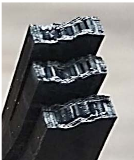
Рис. 6. Структура образцов серии «С» в разломах: а – печать на принтере VSHAPER PRO при 100-процентном заполнении; б – печать на принтере Hercules Strong при 60-процентном заполнении
