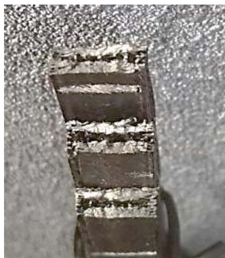
Рис. 6. Структура образцов серии «С» в разломах: а – печать на принтере VSHAPER PRO при 100-процентном заполнении; б – печать на принтере Hercules Strong при 60-процентном заполнении
