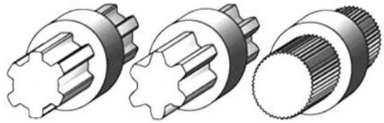
Рисунок 6.5 – Профиль зубьев шлицевого соединения
