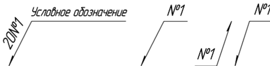
Рисунок 1.12 – Обозначение одинаковых сварных швов
