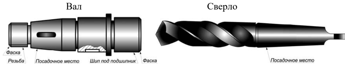
Рисунок 3.4 – Примеры деталей с коническими поверхностями
