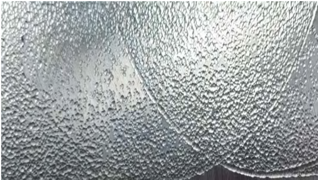
Рис. 1. Алюминиевый образец, обработанный пневмоударным инструментом с различной степенью перекрытия исходной поверхности лунками
