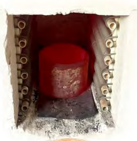
Рис. 1. Проведение предварительной термической обработки: 1 – выдержка при температуре 650 °С в течение 2 ч; 2 – этап быстрого охлаждения в интервале температур 650 °С...400 °С; 3 – этап медленного охлаждения до комнатной температуры (с печью)
