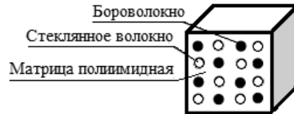
Рисунок 3.4 – Гибридный композитный материал с внутрислойной гибридной структурой
