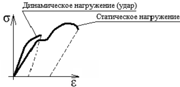
Рисунок 8.2 – Диаграммы растяжения при статическом нагружении и при ударе
