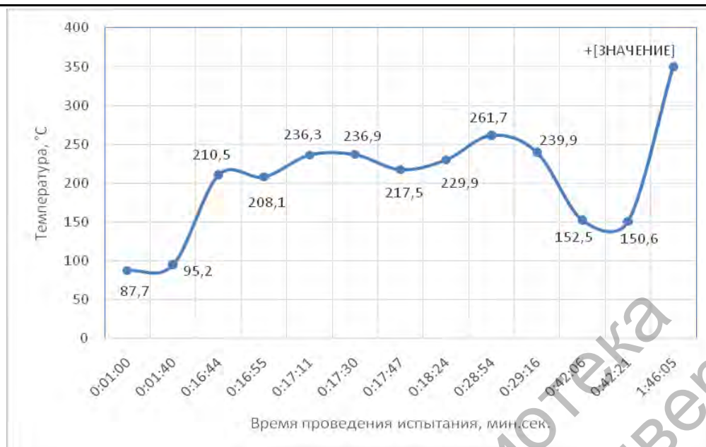
Рисунок 3 – Изменение температуры на поверхности выхлопного тракта во времени
