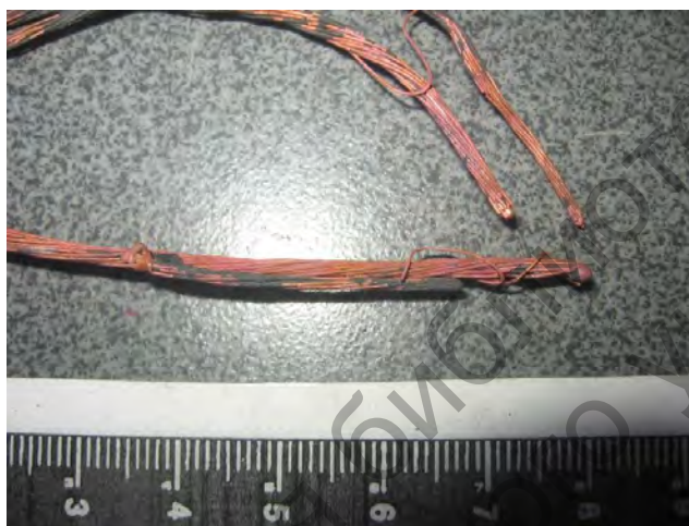
Рисунок 4 – Фрагмент медной многопроволочной токоведущей жилы трактора
