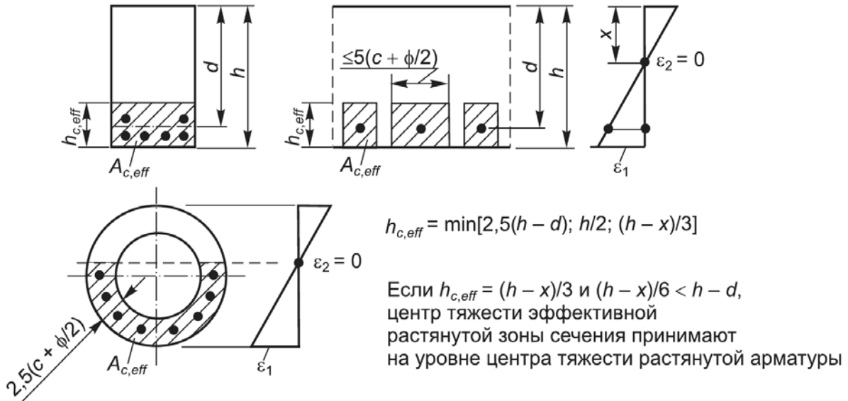
Рисунок 2.1 – Схемы для определения эффективной площади растянутой зоны сечения A_{c,eff} элементов, подвергнутых изгибу или без осевого усилия
