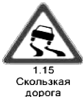
Рисунок 6.3 – Знак (а) и табличка (б), устанавливаемые при несоответствующих значениях коэффициента сцепления требованиям СН 3.03.04–2019 и СН 3.03.06–2022
