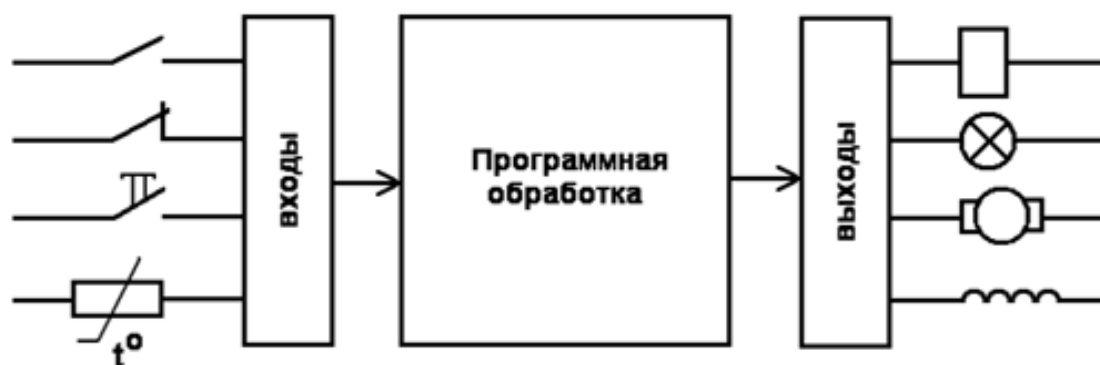
Рисунок 1.1 – Связь ПЛК с датчиками и исполнительными механизмами
