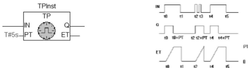
Рисунок 5.3 – Графическое изображение и временные диаграммы таймера TP
