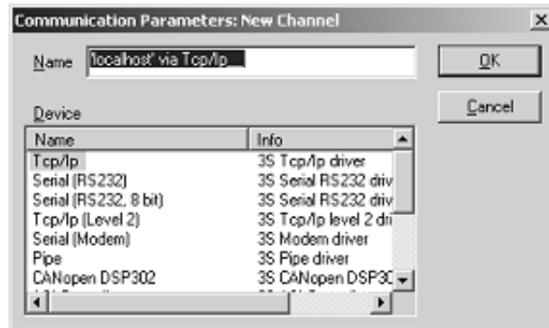
Рисунок 2.23 – Выбор соединения компьютера с ПЛК
