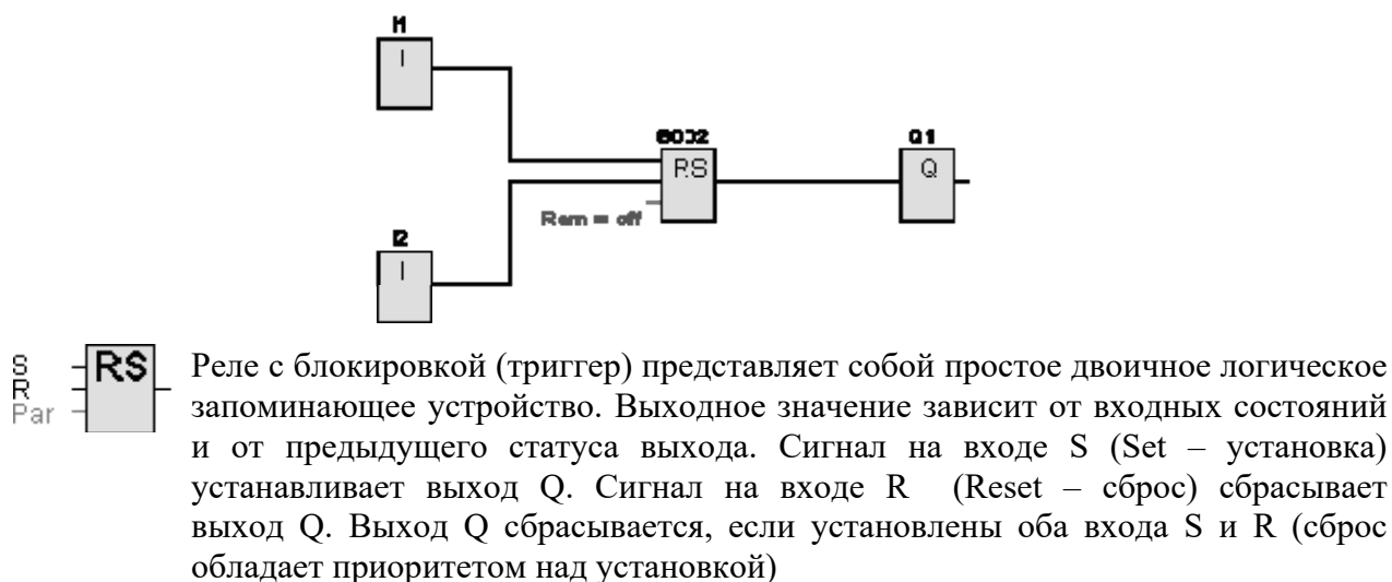
Рисунок 4.2 – Коммутационная программа для тестирования RS-триггера
