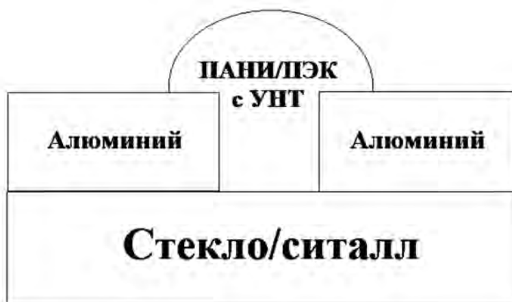
Рис. 1. Структура тонкопленочных резистивных датчиков
