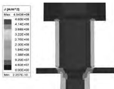
Рис. 1. Математическое моделирование распределения плотности тока при его подводе: а – в торец свариваемого изделия; б – к цилиндрической боковой поверхности изделия
