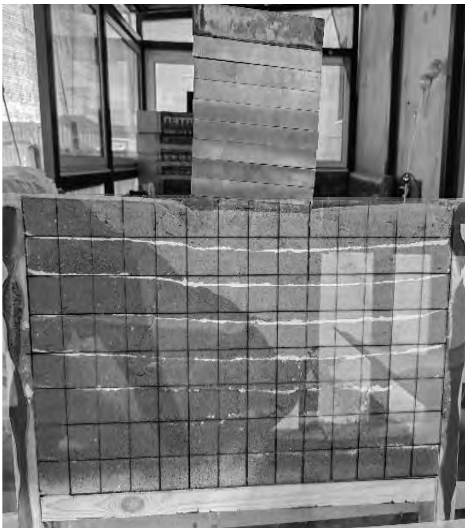
Рис. 3. Результаты осадок после приложенной расчетной нагрузки
