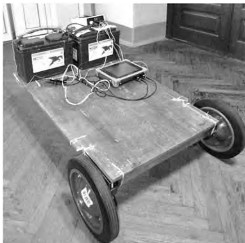
Рис. 2. Прототип мобильной платформы для исследований характеристик ТЭП МТ: а – без нагрузки; б – с нагрузкой
