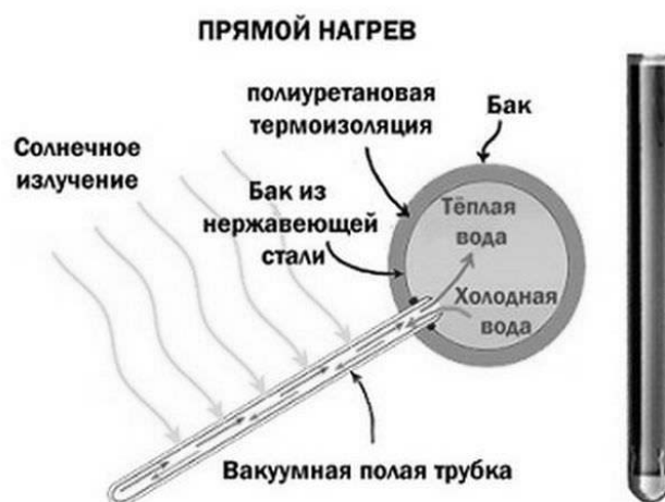
Рисунок 3.3 – Схема работы вакуумного коллектора с прямой теплопередачей воде
