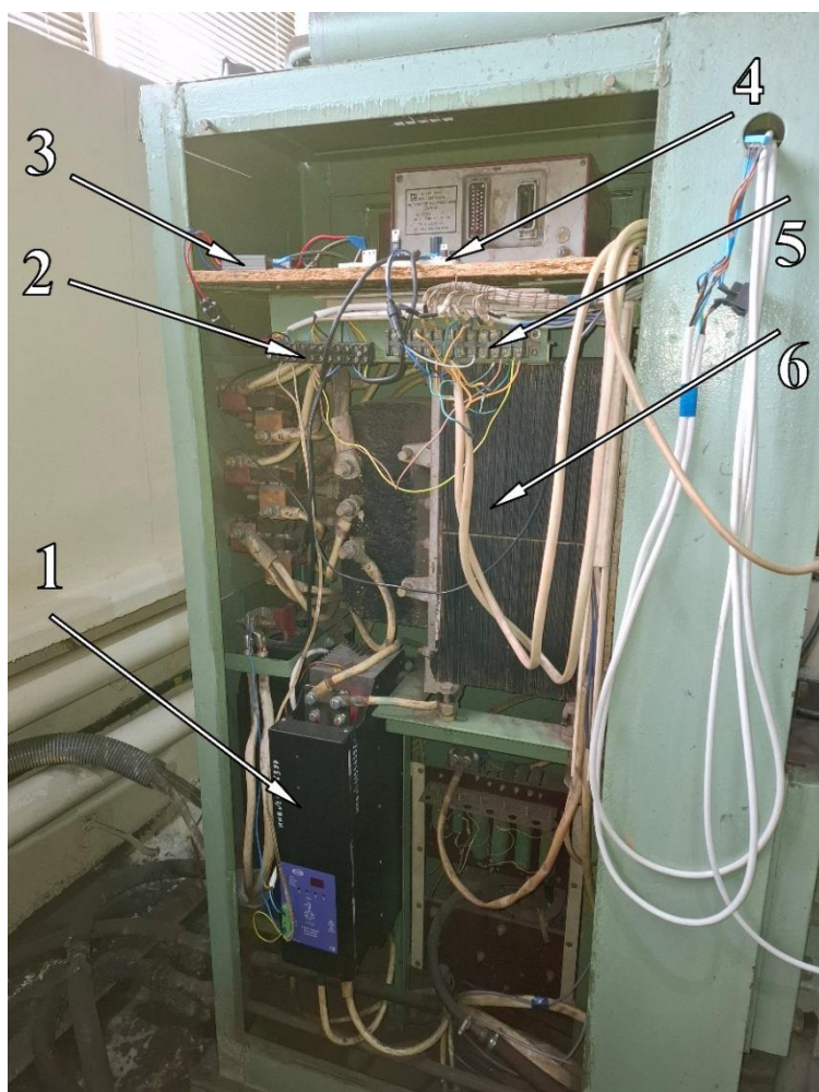
Рисунок 2 – Контактная машина с внедрением системы адаптивного регулирования мощности
