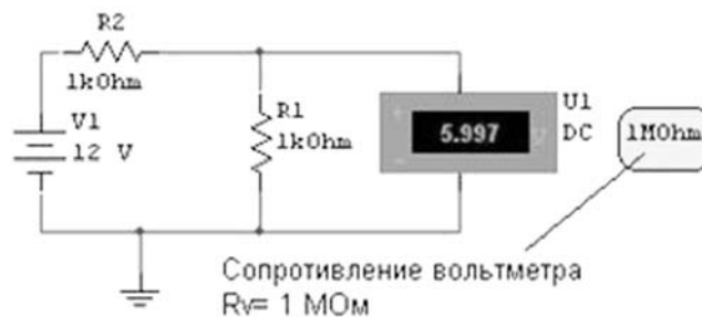
Рисунок 7.3 – Измерение напряжения при помощи вольтметра
