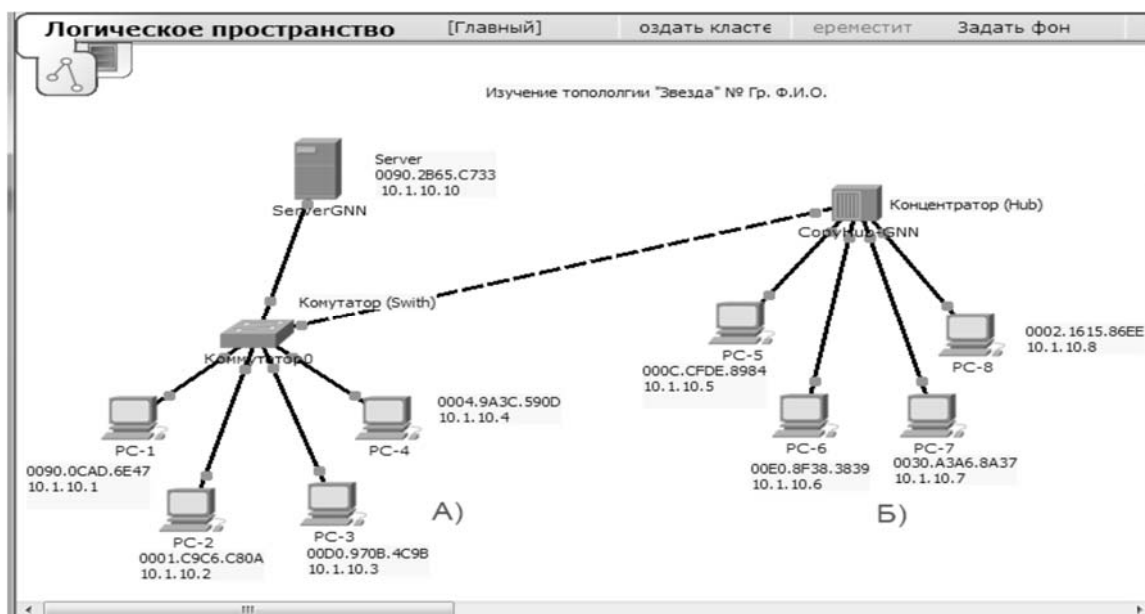
Рисунок 2.5 – Модель сети с использованием коммутатора и концентратора
