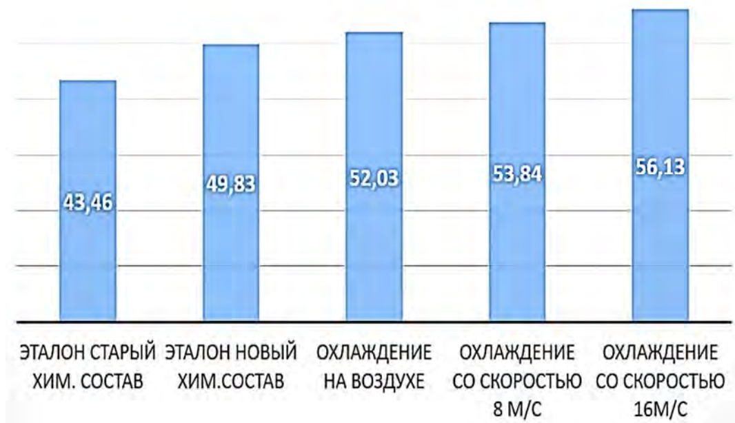
Рис. 8. Средние значения твердости (HRC) по сечению экспериментальных образцов, вырезанных из детали «Конус УЗ-1,1»
