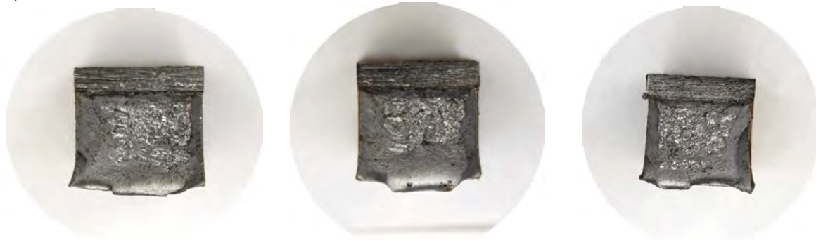
Рис. 3. Внешний вид поверхностей образцов после испытаний на ударный изгиб (-20 °C): а – 82 % Ar + 18 % CO 2 ; б – (Ar + CO 2 ) + 0,25 % SF 6
