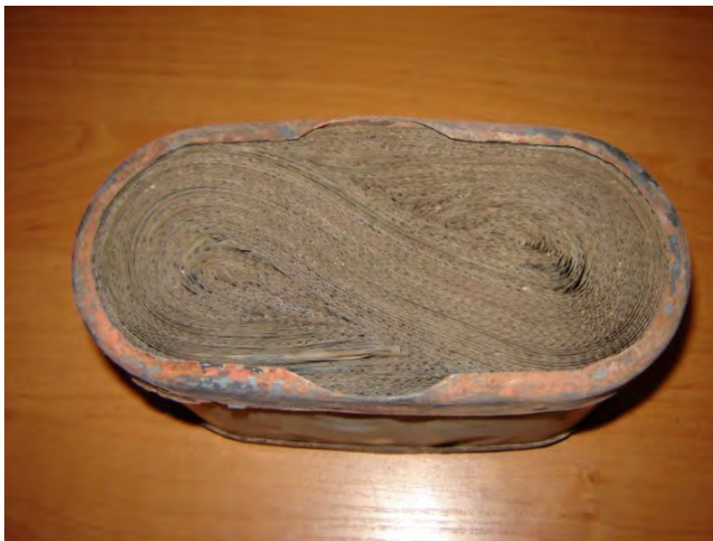
Рис. 4. Каталитический блок с нанесением каталитической композиции
