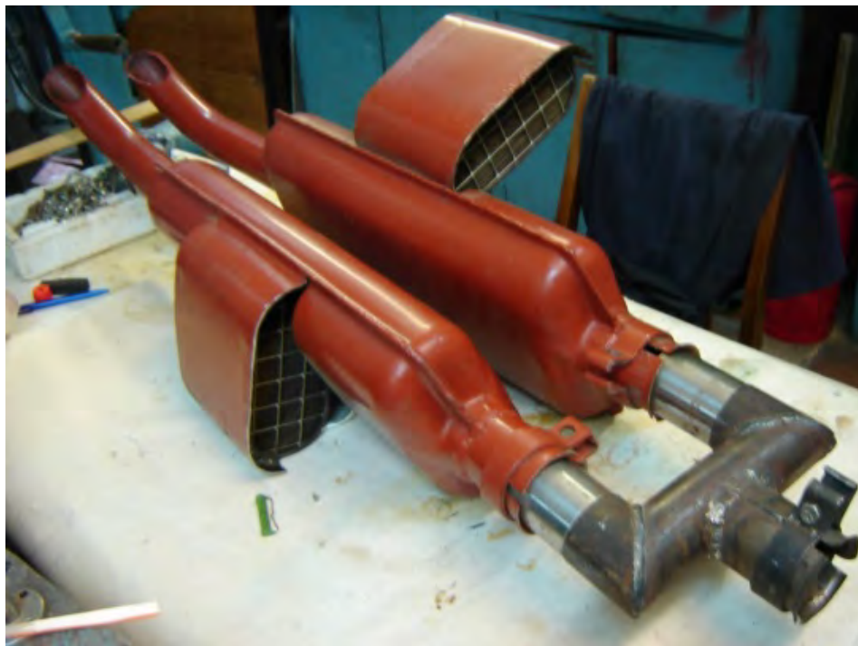
Рис. 7. Глушитель-нейтрализатор, обеспечивающий уменьшение объемной скорости отработавших газов в 2 раза
