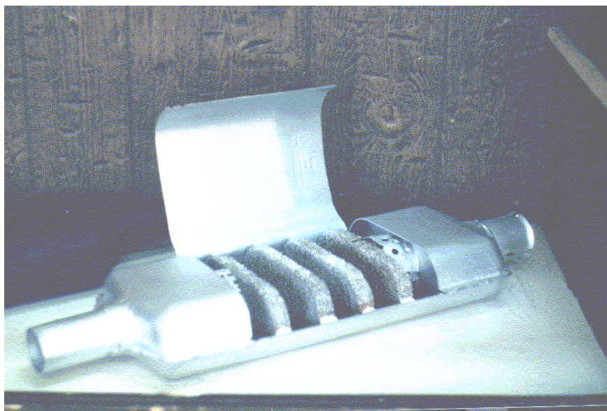
Рис. 2. Нейтрализатор на базе глушителя 60-1205015-А (ММЗ)
