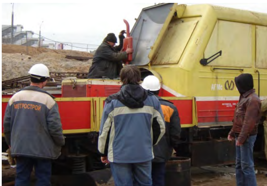
Рис. 6. Установка глушителя-нейтрализатора на дрезину, укомплектованную двигателем ЯМЗ-238 КМ2
