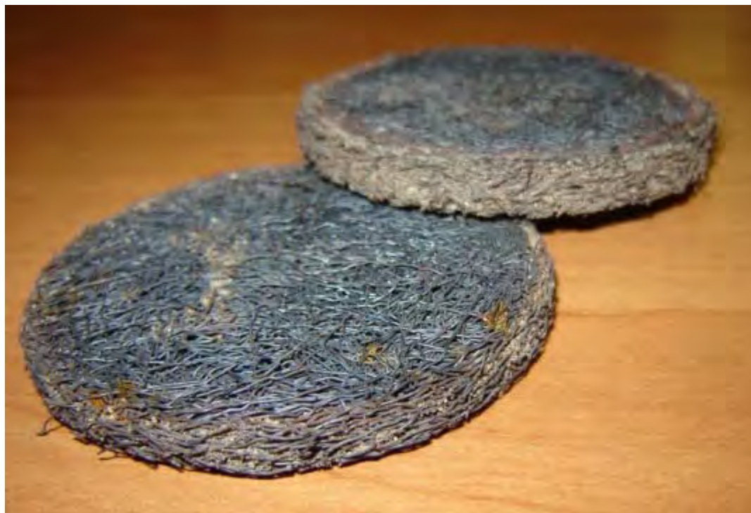
Рис. 1. Макетные образцы носителя каталитического блока, полученные из отходов проволочного производства
