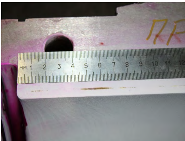
Рис. 7. Результаты капиллярного контроля подшипника
