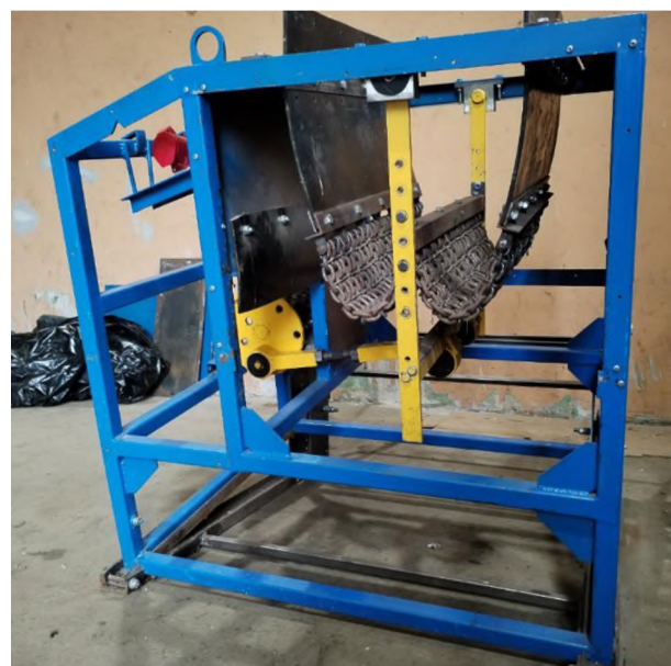
Рис. 2. Общий вид опытно-промышленного образца двухволнового цепного агрегата.
