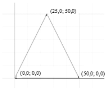
Рисунок 5.7 – Программа обработки фрезой контура «Δ-треугольник»
