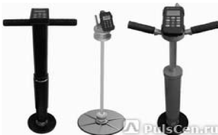
Рисунок 1.5 – Внешний вид динамического плотномера Д-51М с электронным блоком-приставкой Д-51БЭ
