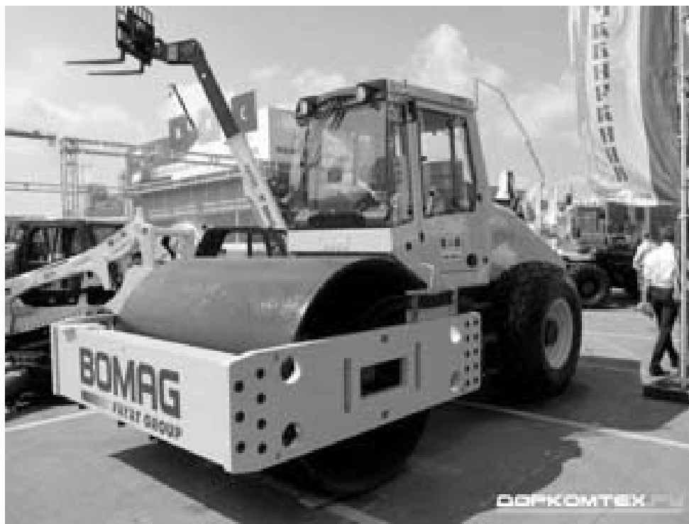
Рисунок 1.9 – Каток фирмы Bomag с прибором Terrameter
