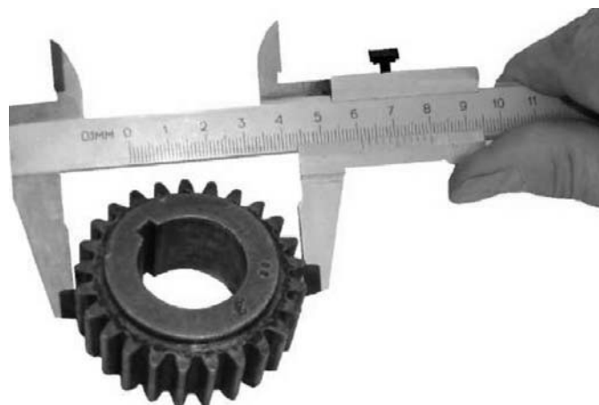
Рисунок 3.7 – Замер диаметра выступов колеса зубчатого
