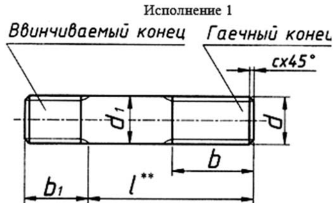
Рисунок 2.12 – Конструктивные размеры шпилек
