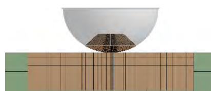
Рис. 2. Гексагональная конечно-элементная сетка модели
