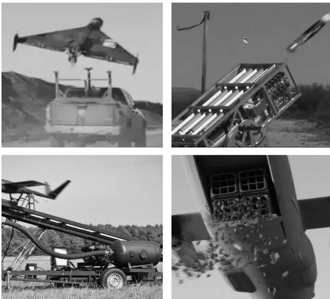
Рис. 1. Методы запуска БПЛА самолетного типа
