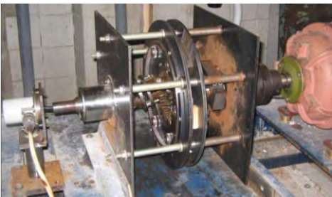
Рисунок 5 – Планетарная плавнорегулируемая передача на стенде
