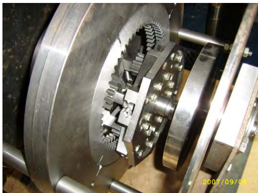
Рисунок 1 – Модификация планетарной плавнорегулируемой передачи с сателлитом в виде СПЗК
