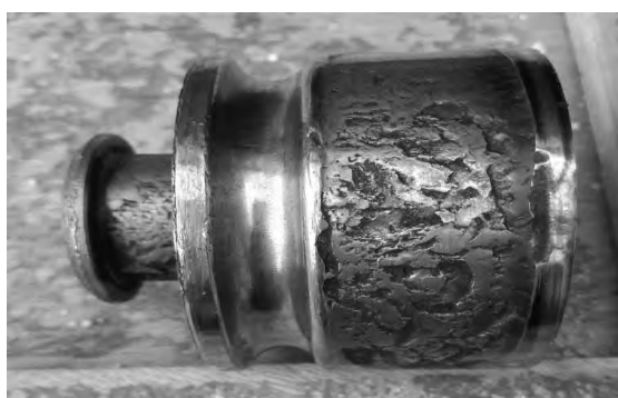
Рис. 1. Вид контактного выкрашивания лапы, изготовленной из стали 19ХГНМА
