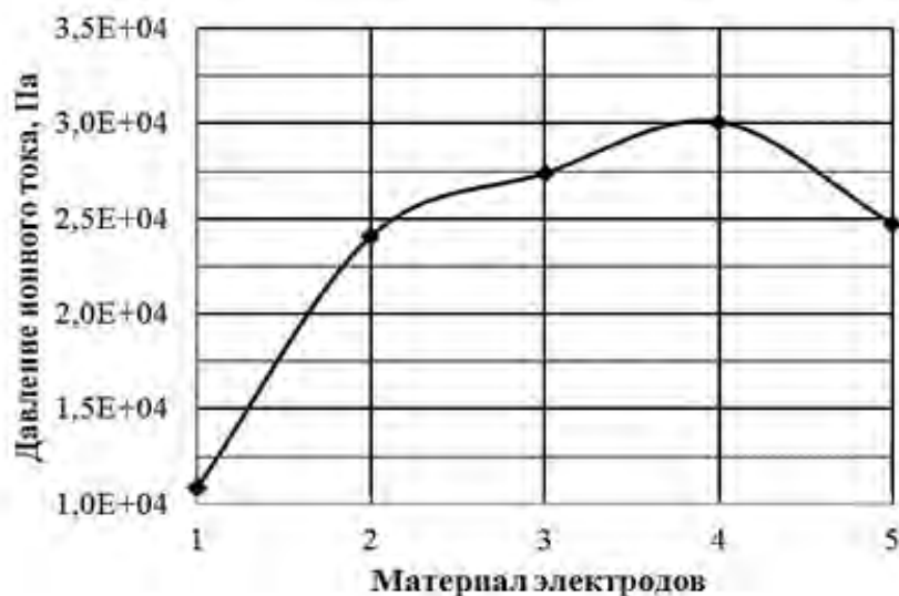
Рис.1. Давление ионного тока на катод сварочной дуги: 1 – Al-Al; 2 – Ti-Ti; 3 – Fe-Fe; 4 – Ni-Ni; 5 – Cu-Cu
