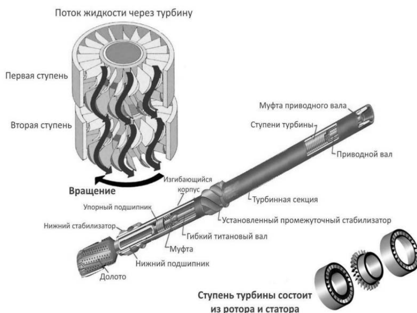
Рисунок 3.1 – Конструкция турбобура и его принцип работы
