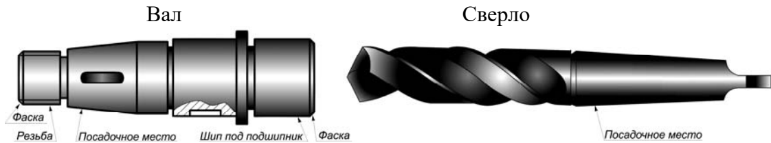
Рисунок 3.4 – Примеры деталей с коническими поверхностями
