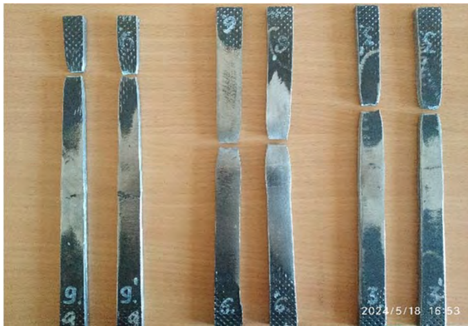
Рис. 2. Разрушение образцов при испытании сварных швов на статическое растяжение
