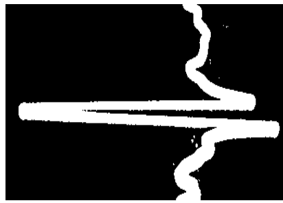
Рис. 1. Вид сигналограммы при магнитографическом контроле с намагничиванием объекта перемещаемым постоянным магнитом через уложенную на его поверхность магнитную ленту: а – при обнаружении дефекта в виде трещины или узкого несплавления; б – при обнаружении широкого поверхностного дефекта (риски, углубления от поверхностных неровностей)
