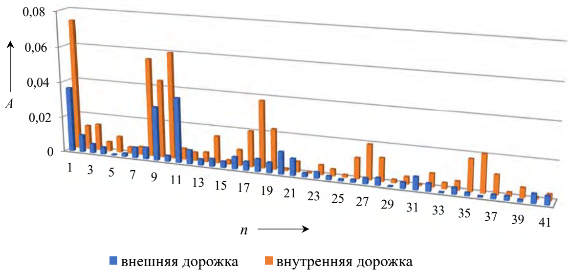
Рисунок 5.105 – Амплитудно-частотные спектры погрешностей профиля многопериодной дорожки диска
