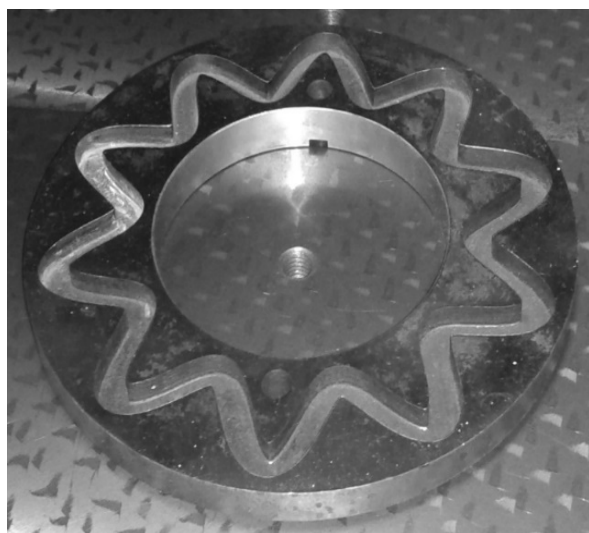
Рисунок 5.103 – Диск с многопериодной дорожкой и его компьютерная модель
