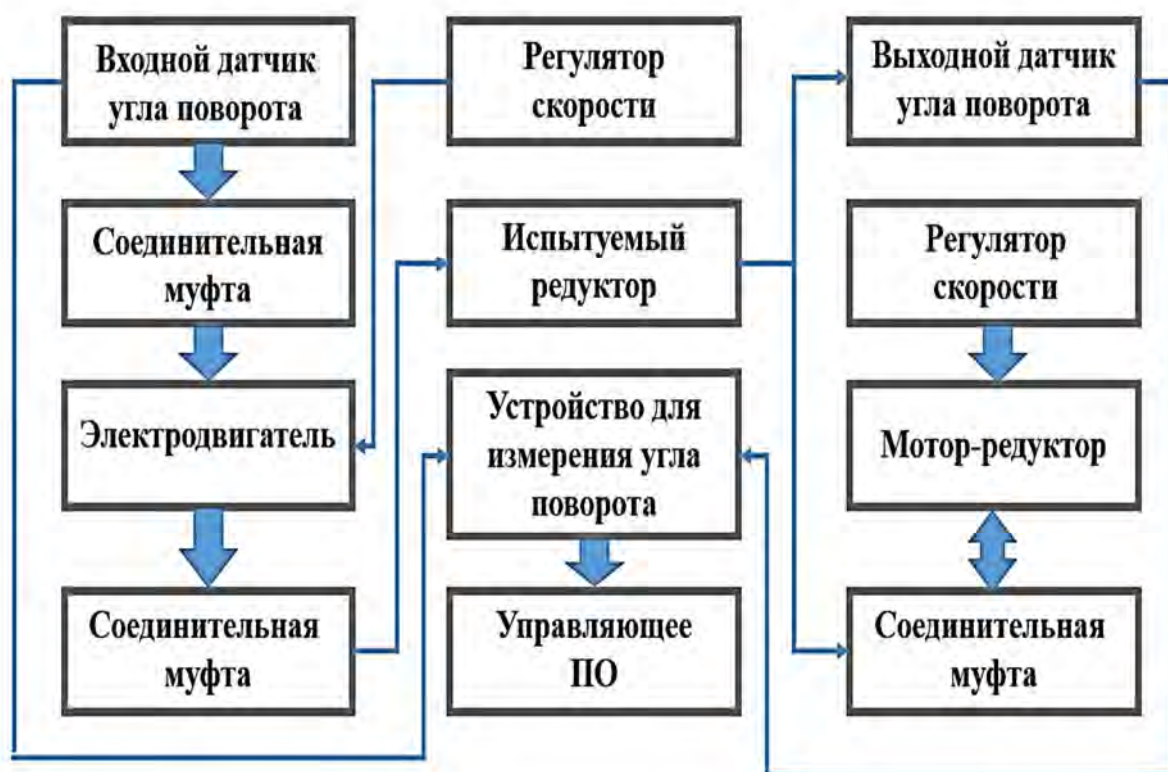
Рисунок 4.9 – Структурная схема энергосберегающего автоматизированного стенда
