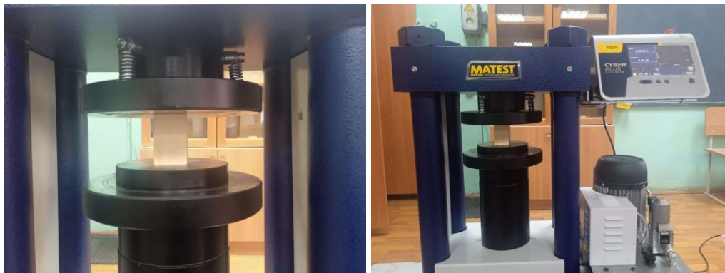
Рисунок 1 – Испытание образца первой партии на сжатие вдоль волокон
