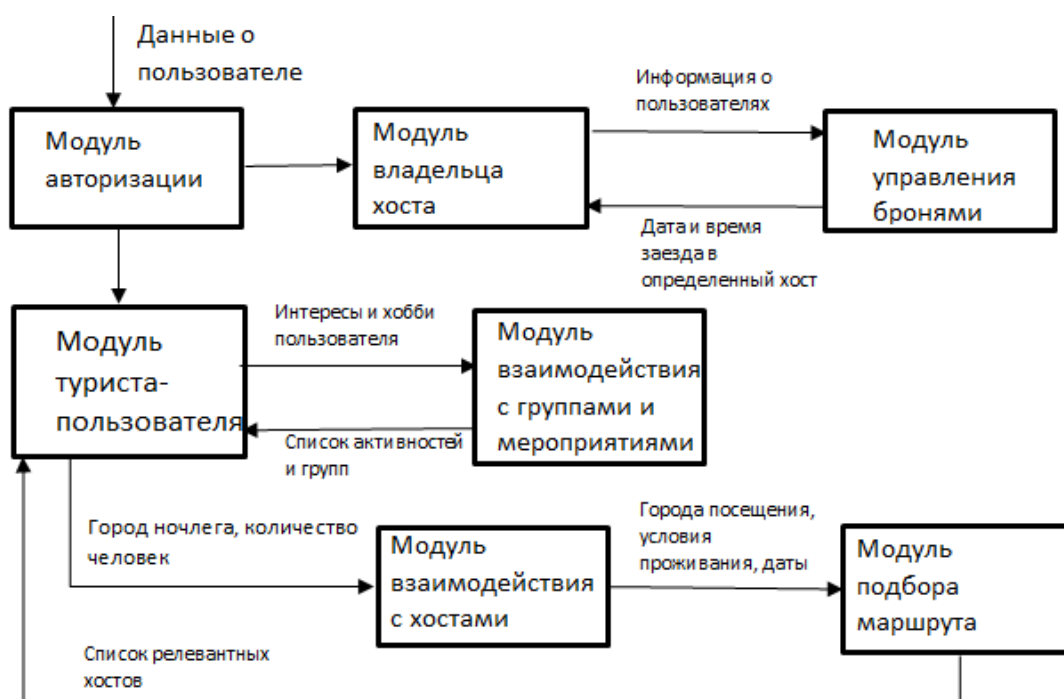
Рис. 2. Схема взаимодействия модулей на онлайн-платформе сети гостеприимств
