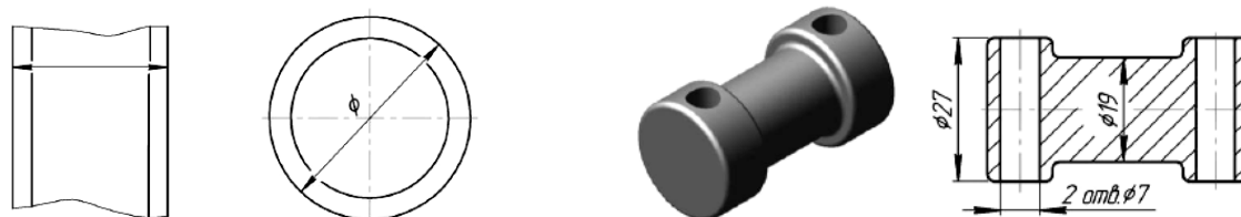
Рисунок 1.8 – Нанесение размера на заштрихованной площади чертежа
