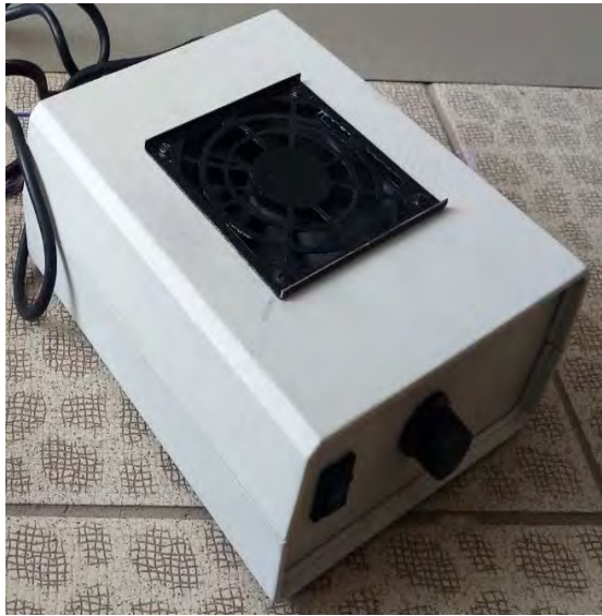
Рис. 4. Экспериментальный силовой блок управления тягового электропривода молочного такси: а – вид в сборе; б – вид со снятой крышкой
