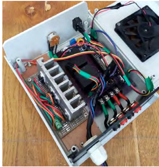
Рис. 4. Экспериментальный силовой блок управления тягового электропривода молочного такси: а – вид в сборе; б – вид со снятой крышкой
