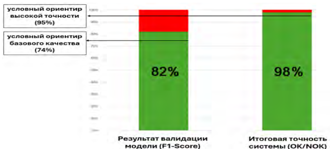
Рис. 9. Сравнение F1-score модели YOLO11s и итоговой точности системы OK/NOK
