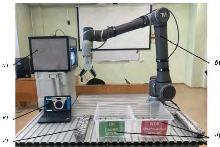
Рис. 3. Экспериментальная робототехническая установка для автоматизированного контроля качества деталей: а – фотобокс; б – промышленный робот TM12; в – ноутбук с программным модулем анализа изображений; г – контролируемые детали; д – контейнеры для сортировки деталей по результату OK/NOK
