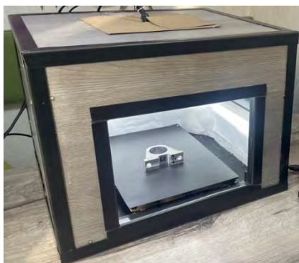
Рис. 2. Фотобокс: а – общий вид фотобокса; б – схема конструкции фотобокса: 1 – несущий каркас; 2 – вертикальная кольцевая LED-подсветка; 3 – боковая LED-подсветка; 4 – камера; 5 – контролируемая деталь; 6 – рабочая поверхность
